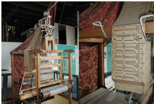
Figura 7.2: Un telar de Jacquard y sus tarjetas perforadas en el Museo de la ciencia y la industria en Mánchester.
